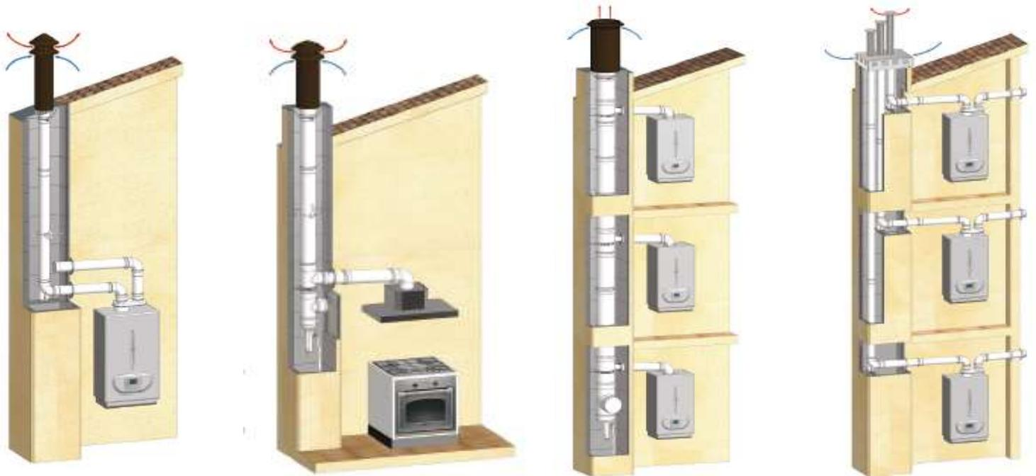
Canale di esalazione, condotto, condotto intubato singolo, multiplo e collettivo per apparecchi a gas e gasolio a condensazione e per cappe cucina con temperatura dei fumi ≤120°C
