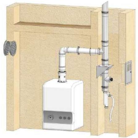
Condotto, condotto singolo e multiplo per apparecchi a gas con temperatura fumi  $\leq 200^{\circ}\text{C}$
