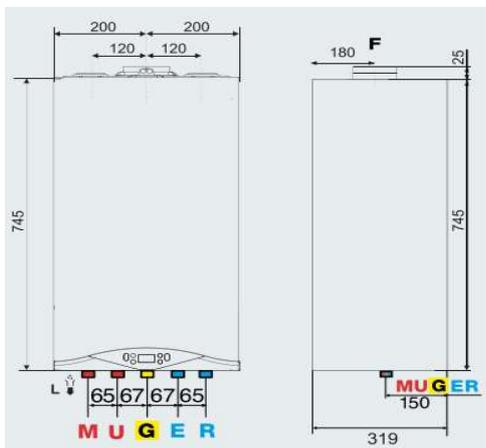
CALDAIA MURALE A CONDENSAZIONE La caldaia murale CARES Premium coniuga la tecnologia della condensazione con la praticità installativa e la compattezza delle dimensioni. Cares Premium è disponibile nella versione riscaldamento e produzione acqua calda sanitaria nelle potenze di 24 e 30 kW
