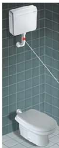
80003735 n.1 - alta posizione per vaso tubo incasso di 200 cm Ø 32-32 mm doppia curva 90° per raccordo tubo alla cassetta Ø 50-32 mm, OR126, guarnizione 6 mm, rosone, curva 90° Ø 32-40 mm, 2 OR138, canotto 22 cm e OR143
