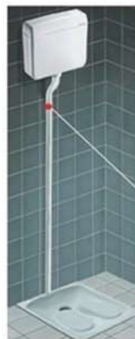
80003500 n.1 - alta posizione per turca, tubo esterno di 200 cm Ø 32-32 mm con raccordo Ø 50 - 32 mm, guarnizione 6 mm, 2 fascette inossidabili con viti
