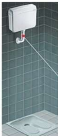
80003835 n.1 - alta posizione per turca - tubo incasso di 200 cm Ø 32-32 mm, doppia curva 90° per raccordo tubo alla cassetta Ø 50 - 32 mm, OR126, guarnizione 6 mm, rosone, curva 90° Ø 32-40 mm e 2 OR138
