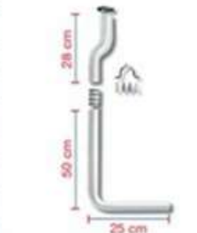
80003370 n.1 - tubo a mezza altezza in 2 pezzi con manicotto, 78 x 25 cm Ø 50 - 40 mm
